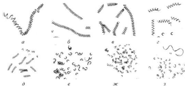
Рисунок 1 – Образцы стружки, полученные при точении с разными значениями главного угла в плане
