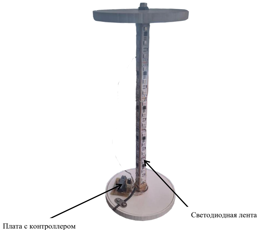
Рисунок 2 – Лампа в сборе , ее устройство изнутри
