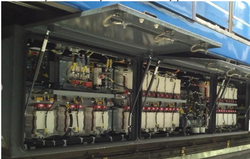
Рисунок 1 – Внешний вид блока тяговых преобразователей электровоза
