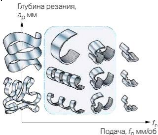
Рисунок 1 – Диаграмма «глубина резания – подача»
