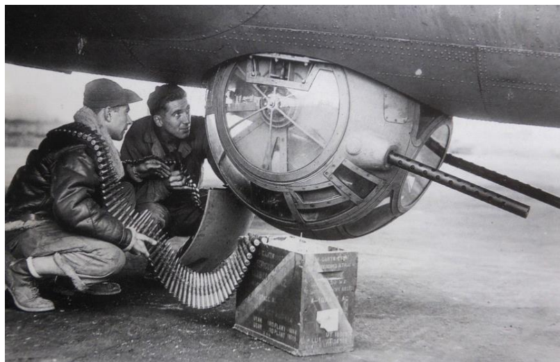
Рисунок 2 – Один из первых прототипов автоматических турелей на самолете Boeing B-17 Flying Fortress
