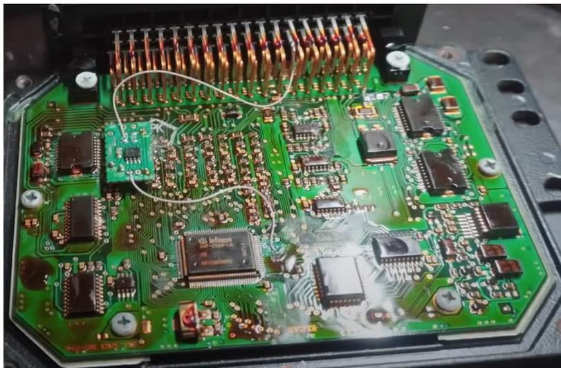
Рисунок 1.2-Вид эбу с установленной платой расширения зажигания.
