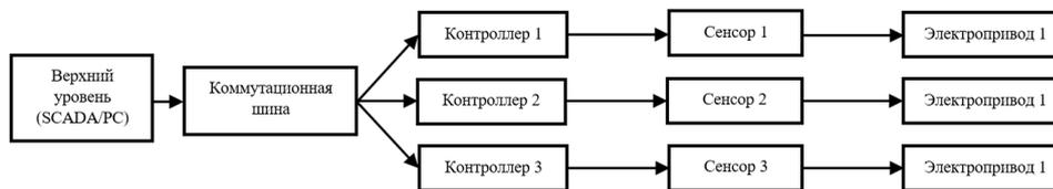
Рисунок 5 - Схема модульного управления с использованием обратной связи
