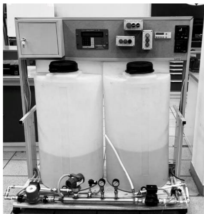
Рисунок 2 – Стенд дозирования реагента
