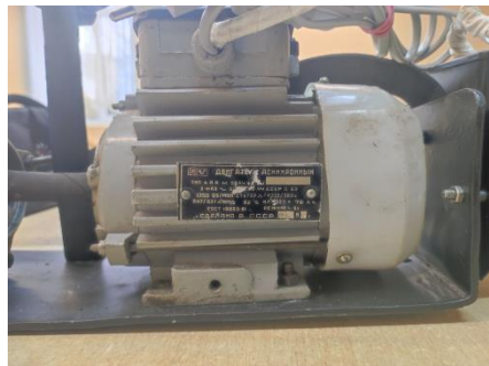
Рисунок 1.1 - Асинхронный двигатель типа 4ААМ 50А4У3
